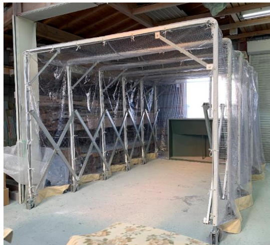
【導入した塗装ブース】
