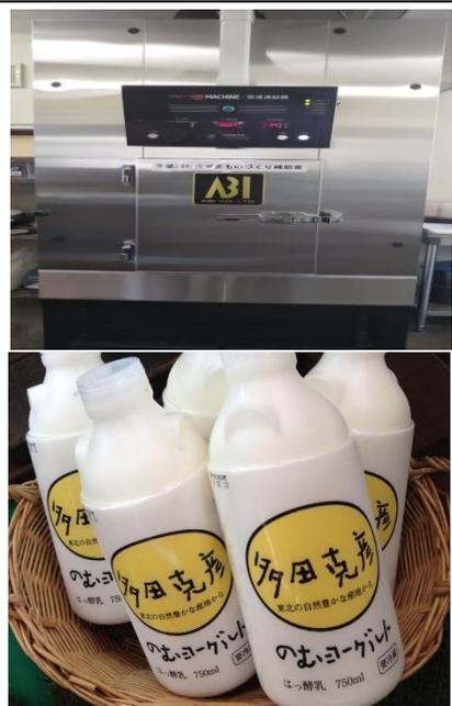
【上：導入した「CAS 装置付き急速冷凍機」
