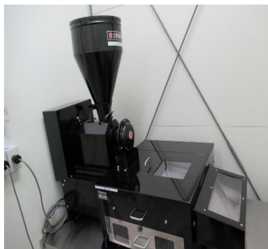
【補助事業で導入した製粉機・篩機（接続した状態）】
