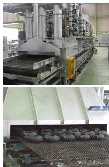
補助事業で導入された「連続炉」
